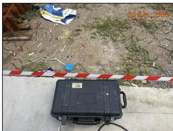
รูปที่ 4.7 การตรวจวัดความสั่นสะเทือน บริเวณพื้นที่ก่อสร้างโครงการ สถานีตรวจวัดแปลงที่ 1
