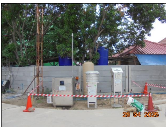
รูปที่ 4.2 การเก็บตัวอย่างคุณภาพอากาศในบรรยากาศ บริเวณพื้นที่ก่อสร้างโครงการ สถานีตรวจวัดแปลงที่ 2
