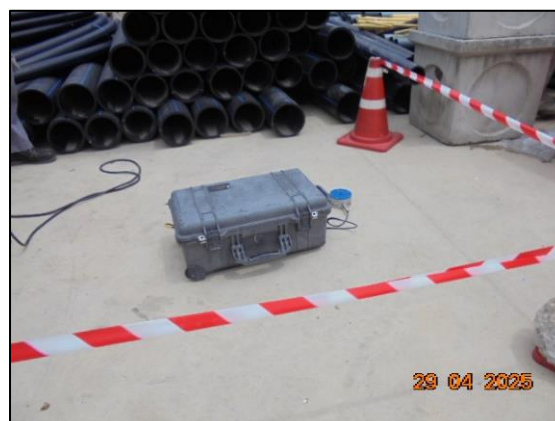
รูปที่ 4.8 การตรวจวัดความสั่นสะเทือน บริเวณพื้นที่ก่อสร้างโครงการ สถานีตรวจวัดแปลงที่ 2
