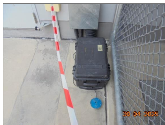
รูปที่ 4.9 การตรวจวัดความสั่นสะเทือน บริเวณ บริษัท เคชเท็ม (ไทยแลนด์) จำกัด สาขาชลบุรี
